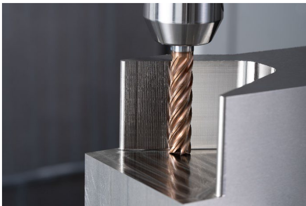
Parte do serviço de consultoria híbrido - Fresa para a usinagem dinâmica e fresagem trocoidal da PFERD TOOLS
